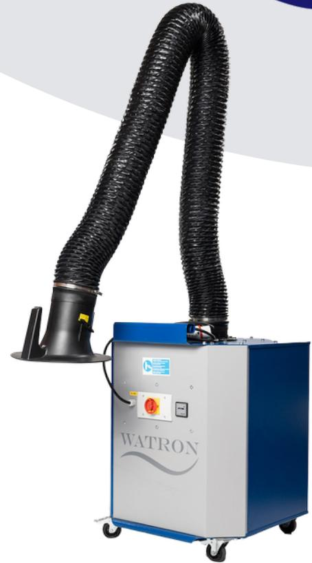
QUAD ist ein hocheffizientes Absaugsystem beim Arbeiten mit Dampf, Rauch, Geruch oder Aerosolen. Der flexible Absaugarm saugt das Material bei einem Durchmesser von 150 mm und 3.300 mm Länge unmittelbar an der Entstehungsquelle ab.
