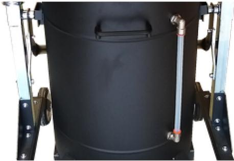
Automatische Füllstandskontrolle. Schwimmer im Spänesieb stoppt vor Überlauf den Absaugprozess
